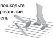
Перевірте цілісність кабелю перед заливанням бетону
